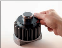
9. Placera axialbricka över lagernålarna.
