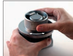
14. Ruckla till alla lagernålar fallit på plats.
