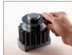
17. Placera axialbricka i över lagernålarna.
