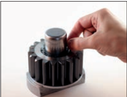
7. Se till att alla lagernålar är på plats.
