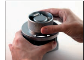
14. Ruckla till alla lagernålar fallit på plats.
