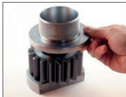
12. Placera monteringsrätt på planethjulet.
