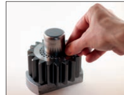
15. Se till att alla lagernålar är på plats.
